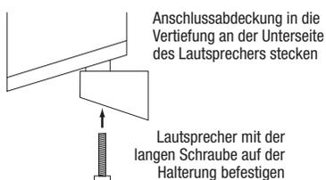
Sie können den Lautsprecher auf der Wandhalterung von links nach rechts drehen. Wenn Sie jedoch versuchen, ihn nach oben oder unten zu kippen, beschädigen Sie die Halterung und unter Umständen sogar die Wand. Diese Schäden werden nicht von der Garantie abgedeckt.
