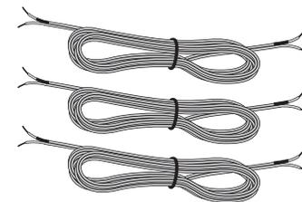
Zwei 12 m-Lautsprecherkabel zur Verbindung des Receivers mit den hinteren Satellitenlautsprechern für den Surround Sound (grau und blau)
